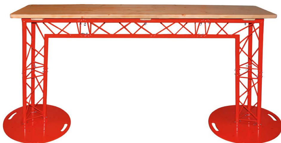
Exemple d'application d'un plateau de structure avec revêtement en poudre rouge. Composé d'une poutre de 100 cm et de deux poutres de 50 cm, deux coins C25 à 90° (pointe intérieure) et deux embases rondes Universal en acier.
